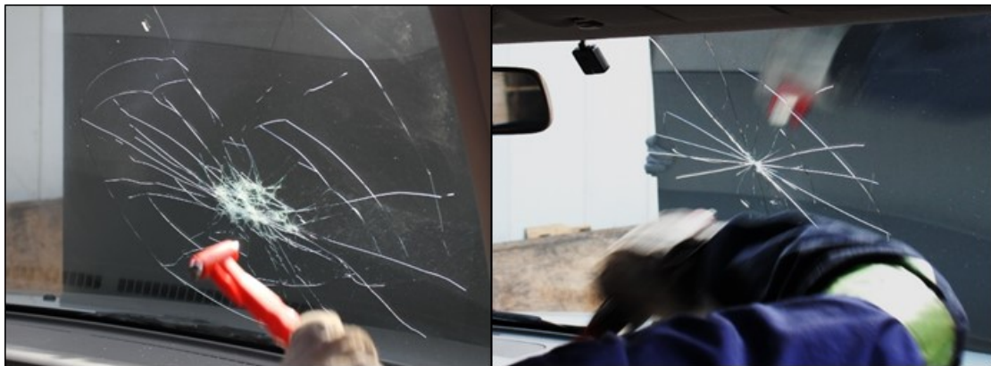
写真7. フロントガラス(合わせガラス)のヒビ(例)
