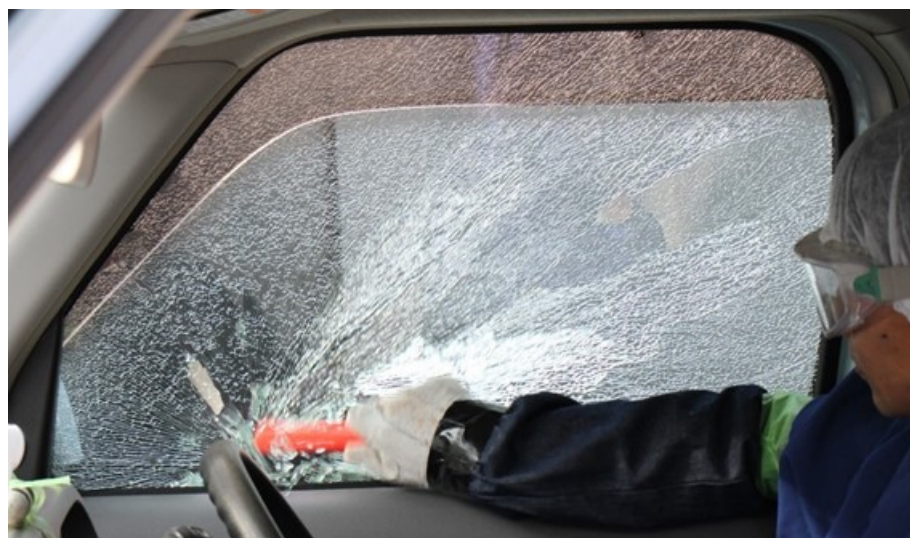
写真6. ドアガラス(強化ガラス)の破碎(一例)
