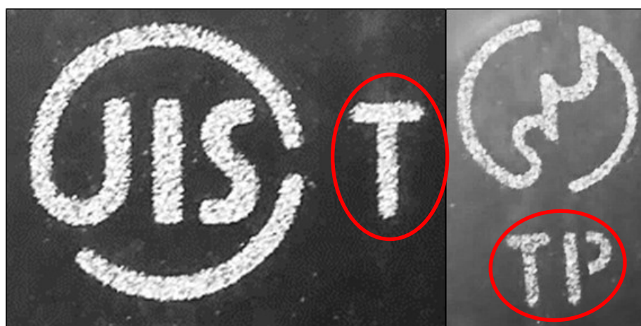
写真2. 強化ガラスを示すマークの例
