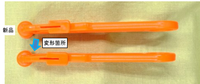
写真11. 柄の変形の例 (No. 3)
